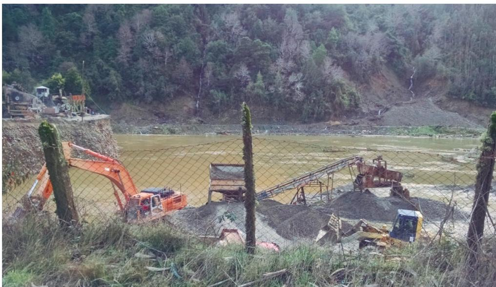
*Figura N°2. Extracción de áridos en el río Trongol, Trongol Bajo. Elaboración propia (2017).*
